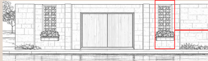
توظيف الزخارف الرأسية بالتكامل مع أحواض النباتات لتعزيز جمالية السور Vertical patterns integrated with planters to enhance the facade
